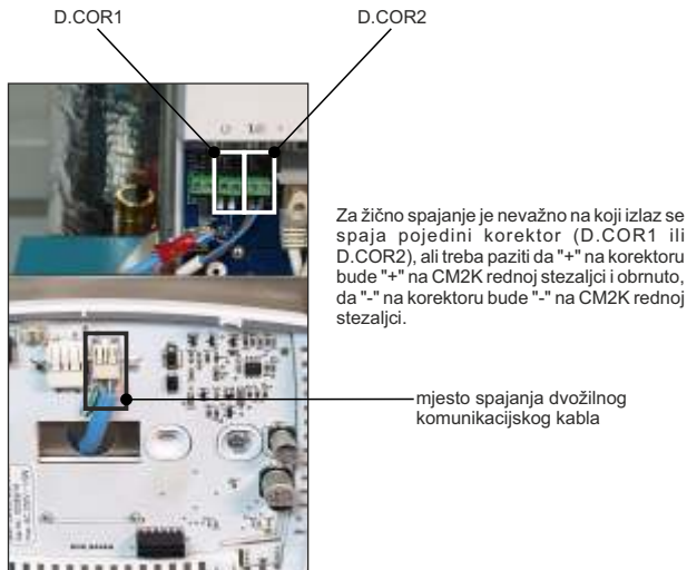
Slika: spajanje dvožilnog kabela
