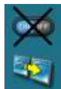
Neki od elemenata automatskog / daljinskog starta kotla su isključeni (Gumbić ON/OFF prekriven crnom bojom)
