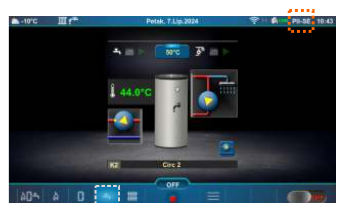
Zaslon potrošne tople vode (PTV) (PII-SE)
